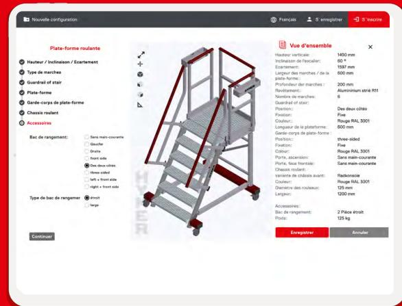
Commande intuitive et visualisation 3D en direct lors de la saisie de paramètres tels que la hauteur, l'inclinaison, l'écartement, le type de marche, la main-courante, la plate-forme ou le garde-corps.
