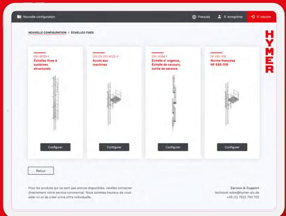
Quatre types d'échelles à crinolines conformes aux normes sont disponibles : pour les bâtiments, les machines, les issues de secours et les installations industrielles.
